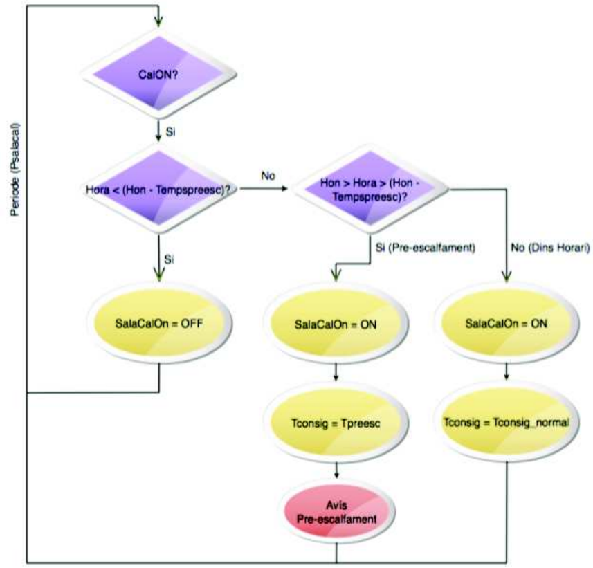
Figura 3: Algoritme de control de pre-escalfament
